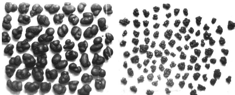
Рис. 5.10. Конгломерат вуглемаляного грануляту з вугілля крупністю: а – 0,1-0 мм; б – 1-0 мм.
